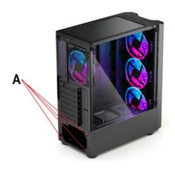
A – Установите блок питания при помощи винтов, идущих в комплекте Поддерживается блок питания формата ATX
