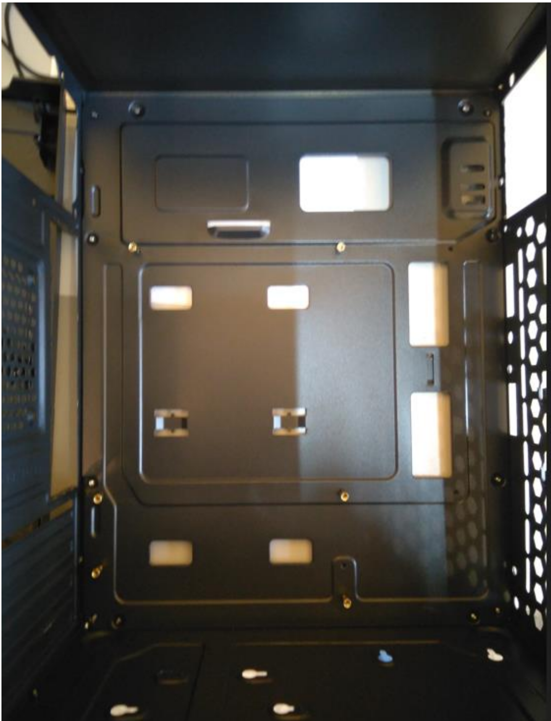
Фото 4. Для установки материнской платы сперва нужно прикрутить крепёжные гайки с внешней и внутренней резьбой.
