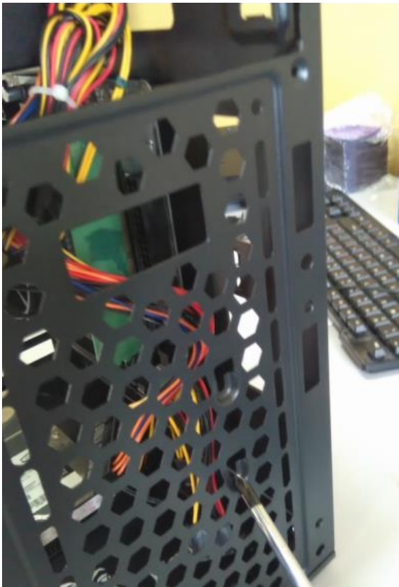
Фото 6. Два паза под винты в корпус HDD 3.5". Вид спереди со снятой пластиковой лицевой панелью.
