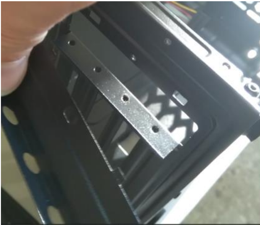
Фото 2. Крепление-планка удалена, видны освобождённые отверстия с резьбой.
