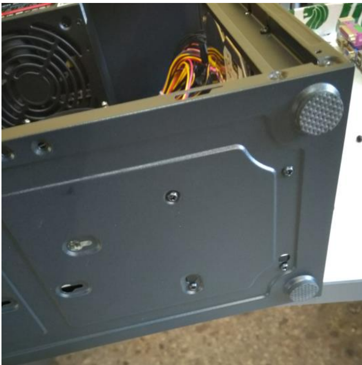
Фото 11. На фото видна комбинация установки двух носителей HDD 3.5" и SSD 2.5" .
