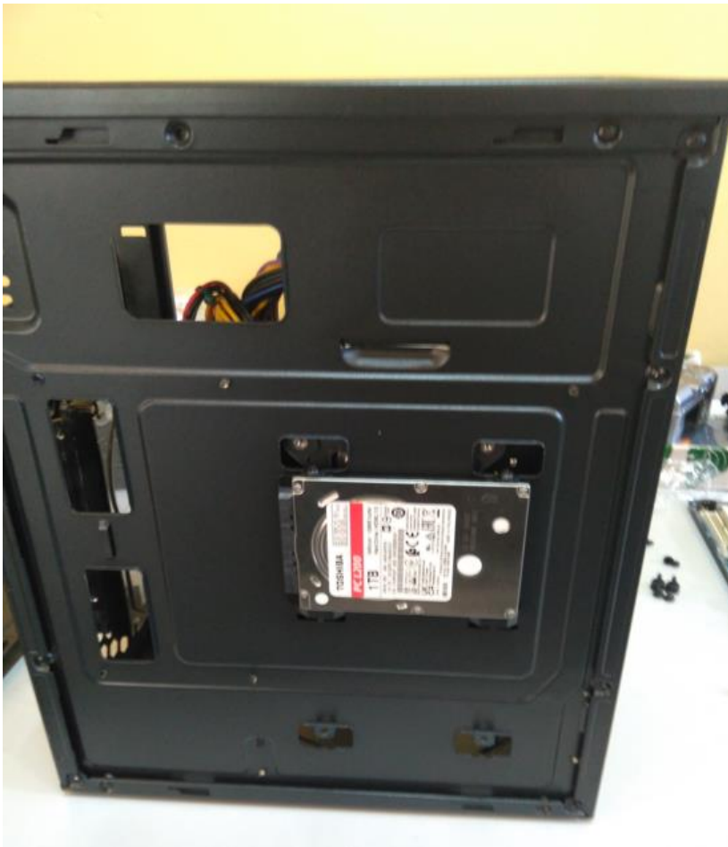
Фото 16. Показана установка HDD 2.5".
