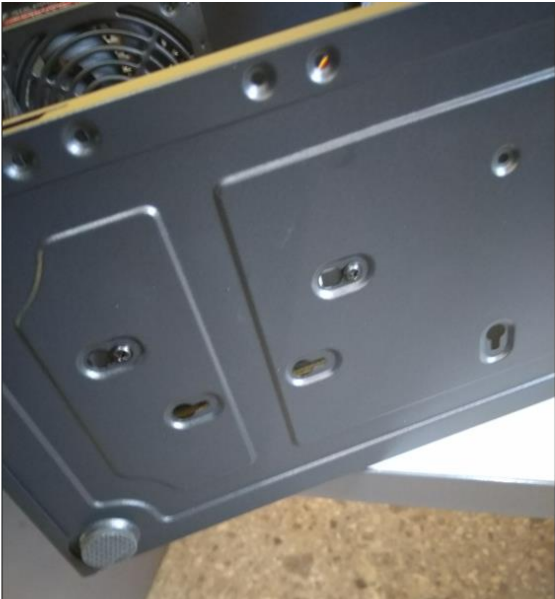
Фото 10. Показано крепление SSD 2.5" снизу корпуса.
