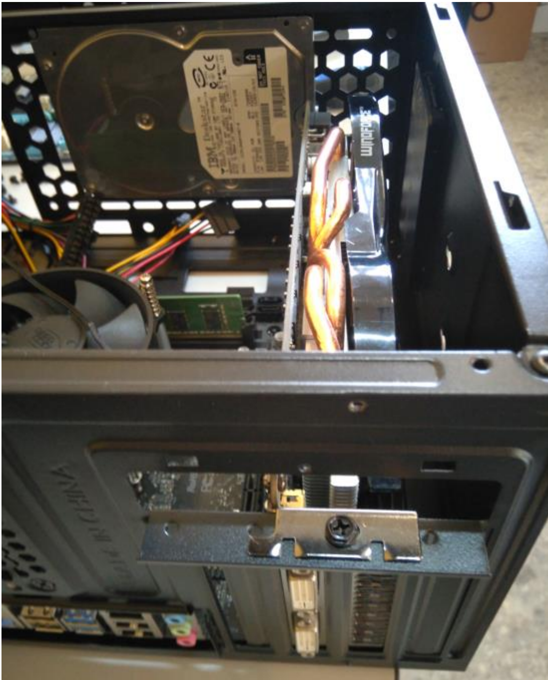
Фото 5. Видеокарта с креплением к корпусу, вид сверху.
