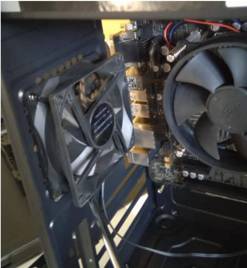
Фото 2. Установленный вентилятор 80мм на задней стенке корпуса. (Винты крепления вентилятора не входят в комплектацию корпуса).
