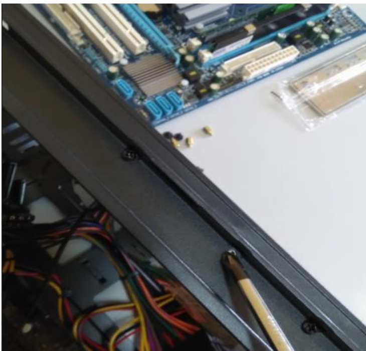
Фото 7. Затягиваем 3 винта с небольшим усилием до конца. А также не забываем затянуть 2 винта на передней части корпуса, как показано на Фото 3 и Фото 2.
