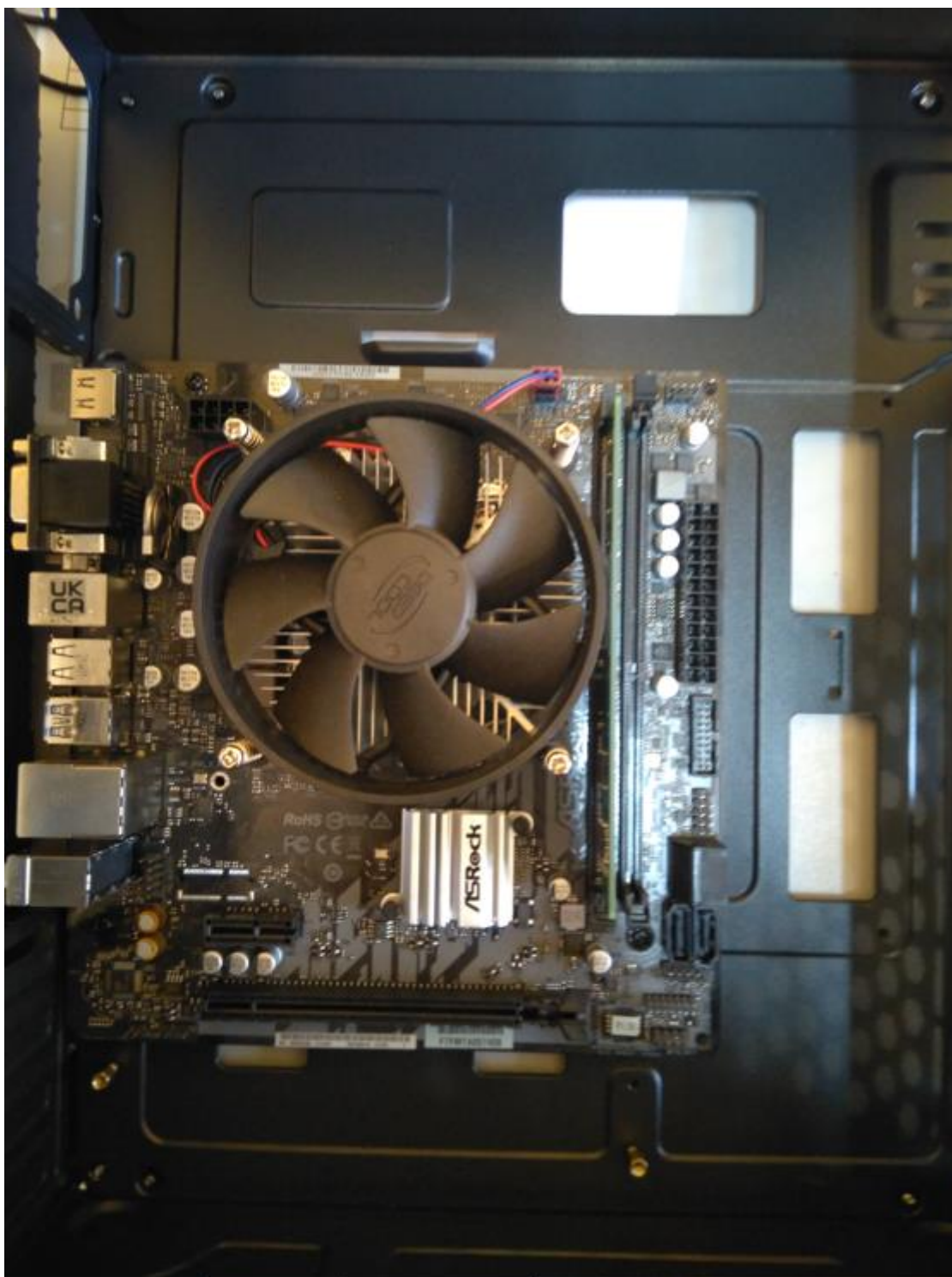
Фото 5. Установленная плата форм-фактора MiniATX - 170x170 mm. Ниже под платой видны две стойки для установки платы форм-фактора MicroATX 244x244 mm, или 244x225mm.
