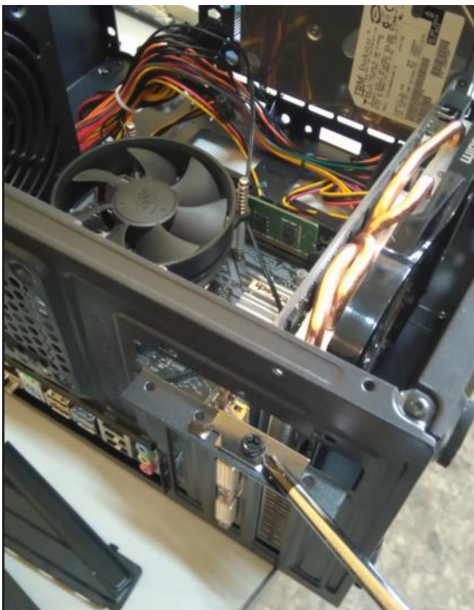
Фото 3. Установленная видеокарта в слот PCI-е и винт крепления, прикрученный к корпусу.
