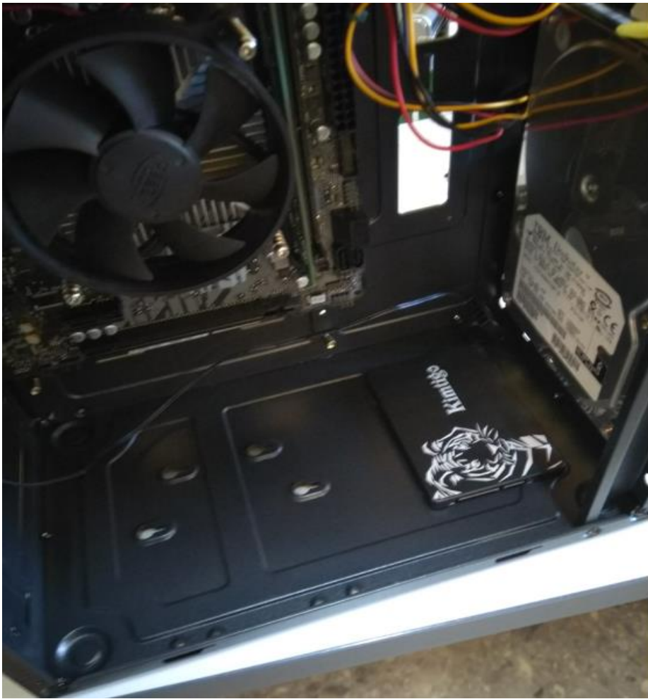
Фото 11. На фото видна комбинация установки двух носителей HDD 3.5" и SSD 2.5" .
