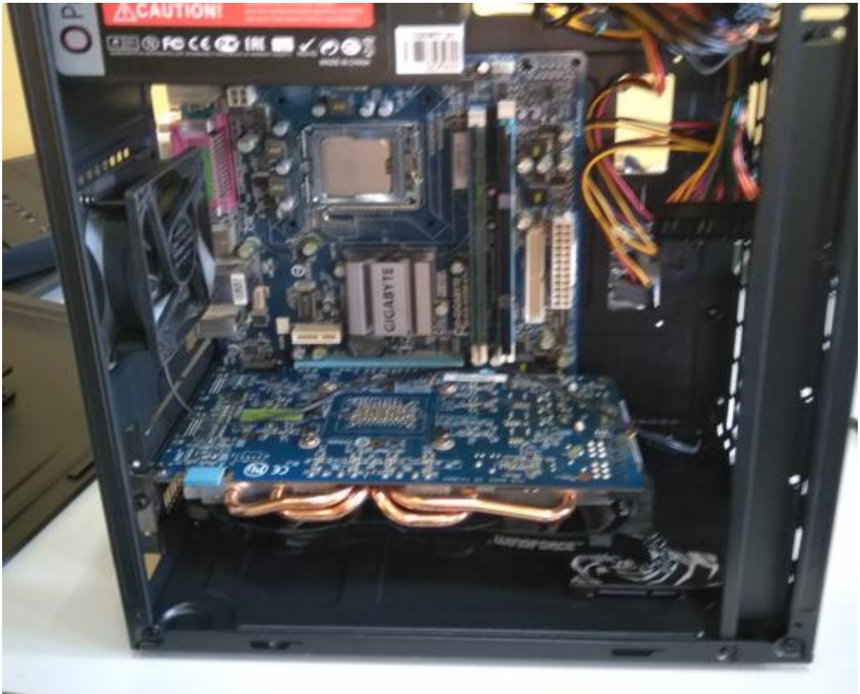
Фото 6. Установленная видеокарта на материнской плате форм-фактора MicroATX- 240x225 mm. (Максимальная длина видеокарты - 240мм для этого корпуса ПК).
